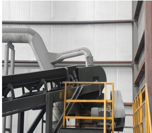
中频炉配套的破碎集气罩及集气管道
